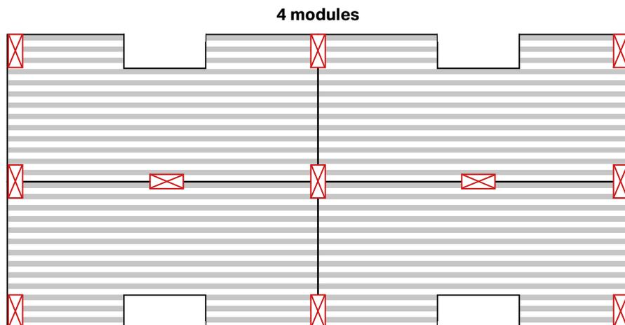
Dans le cas d'un grand tapis les éclisses seront positionnées de manière à maintenir chaque module au sol et à raccorder tous les modules entre eux.
